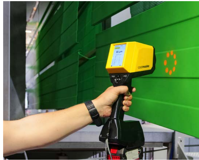
Die geringe Messdauer von 0,25 Sekunden und eine Winkeltoleranz von \pm 70^\circ ermöglichen auch Messungen auf schwankenden Teilen.
